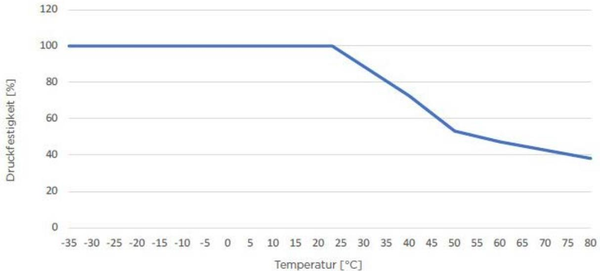
Ausnutzungsgrad der zulässigen Druckfestigkeit (%) in Abhängigkeit von der Temperatur (°C).
